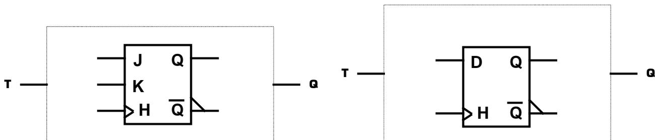
Pour réaliser une bascule T avec une bascule JK, on utilise le monde de fonctionnement « basculement » [J=K=1], et pour réaliser une bascule T avec une bascule D on relie D à la sortie complémentaire.
