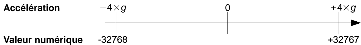
Figure 13 : correspondance entre les accélérations mesurées et les nombres envoyés par l'accéléromètre avec g \approx 9,81 \text{ m}\cdot\text{s}^{-2}
